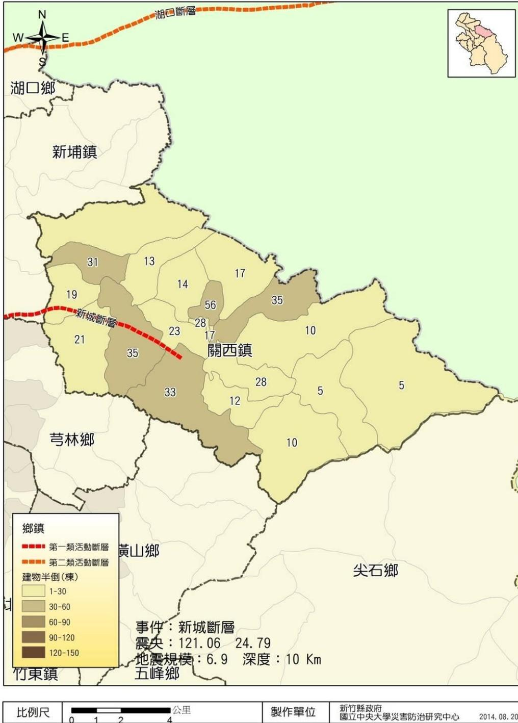
圖 13 關西鎮新城斷層規模 6.9 地震事件建物半倒分布圖
